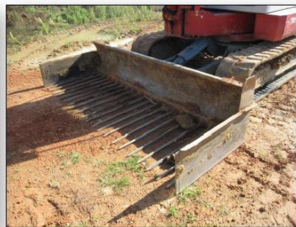
Pelle mécanique adaptée au prélèvement et au transport de dalles de terre.
