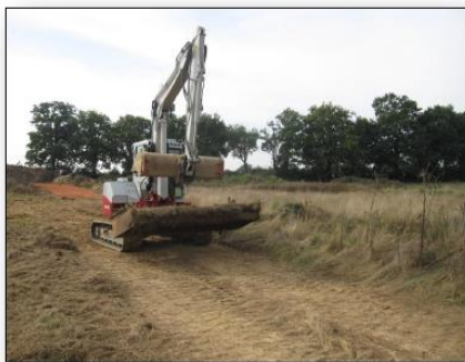
Pelle mécanique adaptée au prélèvement et au transport de dalles de terre.
