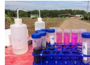
(2) Test POXC, mesure au spectrophotomètre de terrain
