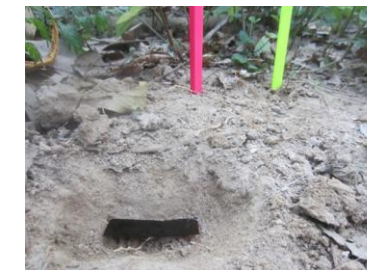
(3) Méthode par membrane échangeuse d'ions
