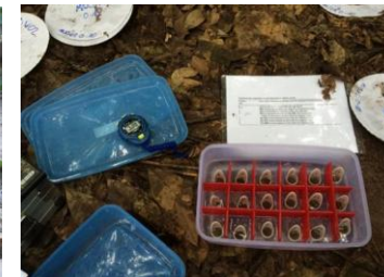
(4) Méthode de dispersion des agrégats dans l'eau
